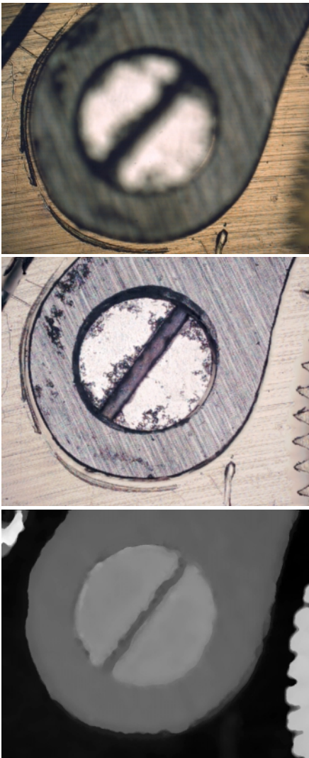
Abb. 2a: Bild aufgenommen mit konventioneller Technologie. Deutlich ist der geringe Schärfentiefebereich und die ungleichmäßige Ausleuchtung erkennbar. Abb. 2b: Bild aufgenommen mit dem voll-digitalen Mikroskop. Das Bild ist über den gesamten Tiefenbereich scharf und gleichmäßig ausgeleuchtet. Abb. 2c: Die robusten und genauen Resultate ermöglichen eine exakte Tiefenbestimmung. Hier sind tiefere Bereiche dunkler als höhere Bereiche dargestellt.
